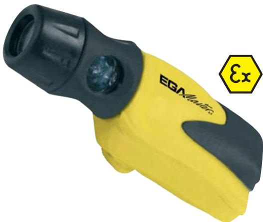
La linterna MasterEx 79641 está equipada con un led blanco de potencia de 3W y uno rojo de alta intensidad que emite un destello papadeante y orientable. Perfecta para uso en ambientes explosivos peligrosos, hasta zona 0 y 20, conjugando resistencia y potente iluminación. Fabricada en resina termoplástica de alta resistencia a los impactos, las temperaturas extremas, los líquidos y sustancias corrosivas.
