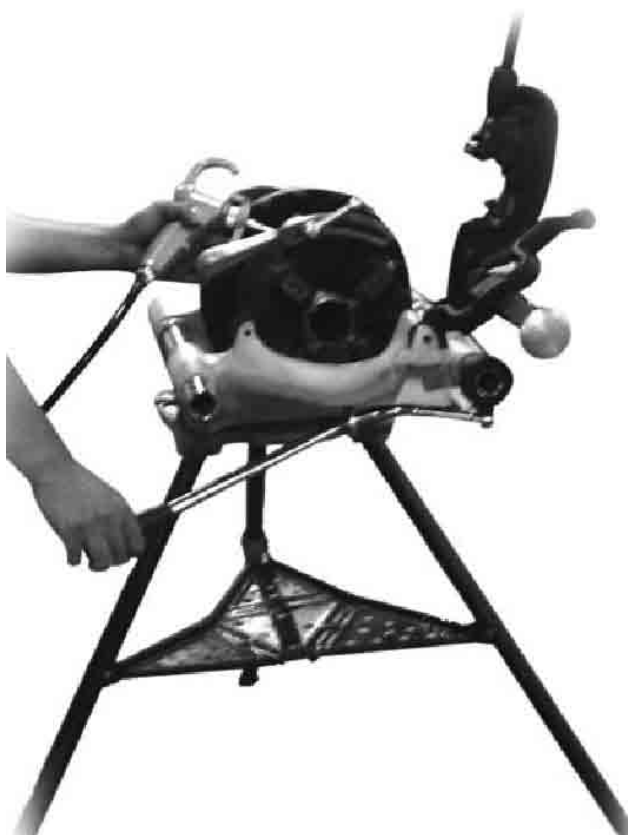
Operación de roscado del tubo
