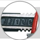
**3.** Mordaza inferior reemplazable de aleación de acero. Dientes sesgados, fresados con gran precisión para maximizar la fuerza de agarre y la vida útil de la herramienta.
