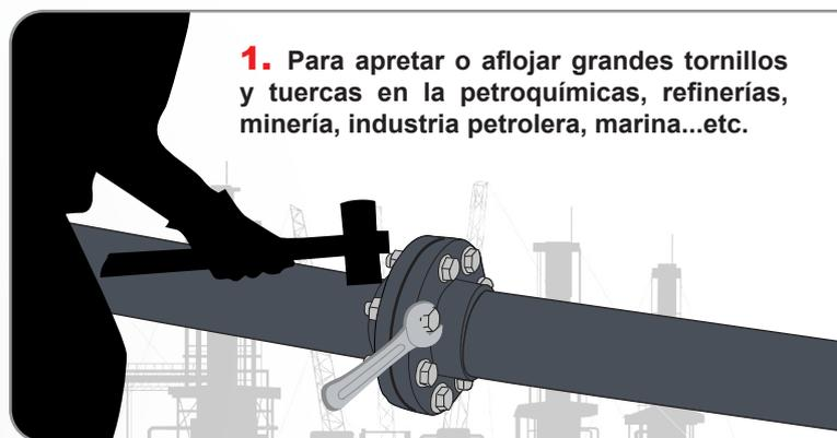
**1.** Para apretar o aflojar grandes tornillos y tuercas en la petroquímicas, refinerías, minería, industria petrolera, marina...etc.
