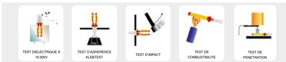
**Test d'adhérence** : vérifie l'adhérence du matériau isolant aux éléments métalliques de l'outil.
