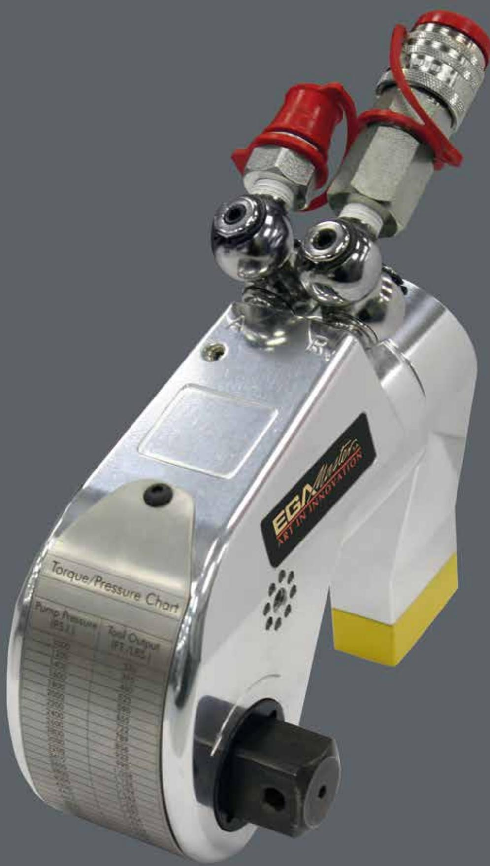
Las llaves hidráulicas dinamométricas de EGA Master han sido diseñadas para el apriete controlado de conexiones tuerca-perno. El movimiento de rotación del conjunto tuerca-perno se consigue a través del flujo hidráulico y presión suministrados por las bombas hidráulicas EGA Master, con mando remoto para controlar el avance y retroceso del flujo hidráulico.
