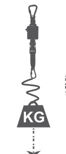
Se une el lanyard a un punto de anclaje y al otro extremo se le aplica la carga. La carga se eleva y se suelta verticalmente, 5 veces.
