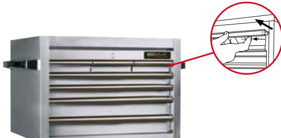
Sistema antivuelco con botón de seguridad de apertura individual por bandeja
